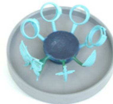
Einzelne Stücke oder mehrere Teile werden für den Guß vorbereitet.
